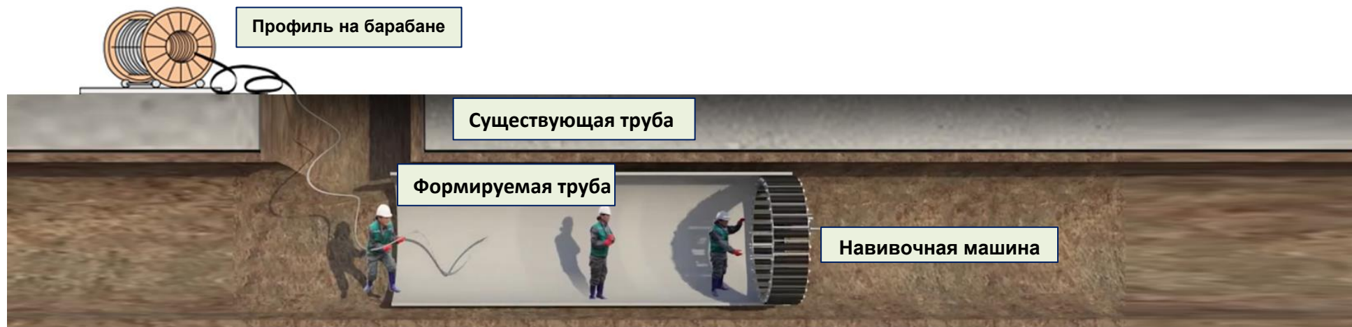
Схема формирования трубы в существующем коллекторе Ду1900 мм
